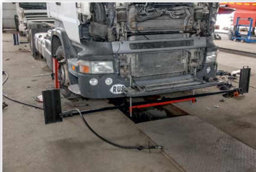
Проверка и корректировка углов установки колес – важное условие для достижения максимального эффекта от применения энергосберегающих шин
