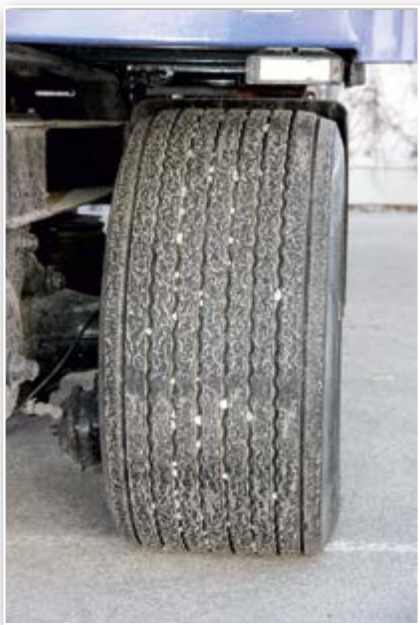
Сверхширокие шины – перспективное направление, позволяющее значительно снизить сопротивление качению при замене спаренной ошиновки
