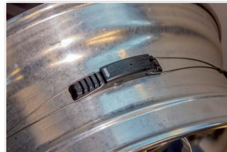
Давление и температуру воздуха в шинах удобно контролировать при помощи специальных датчиков, сигнал от которых поступает на электронный блок системы Tire Pressure Monitoring System (TPMS). Данные выводятся в цифровом виде на установленный в кабине ж/к монитор
