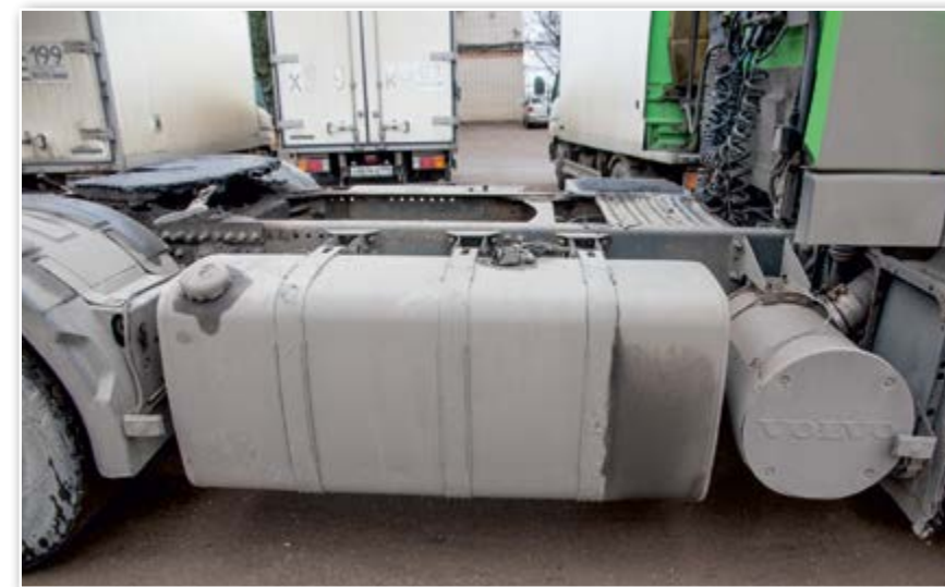
На машинах с большими пробегами рекомендуется выполнить промывку топливных баков. За сотни тысяч километров в них может накопиться много отложений
