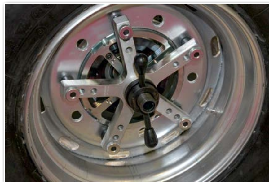
Балансировка колес с применением высокоточных адаптеров позволяет максимально нивелировать дисбаланс и продлить срок службы энергосберегающих шин. Чем больше они пройдут километров, тем больше сэкономят денег
