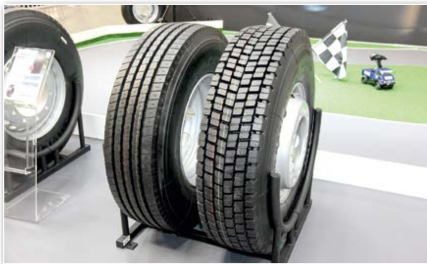
Интенсивность процесса тепловыделения зависит от рисунка протектора
