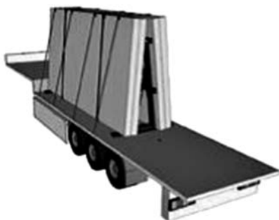
Rys. 7. Mocowanie za pomocą połączenia blokującego, A-kształtnego stojaka, odciążów przepasujących i przepasania od góry
