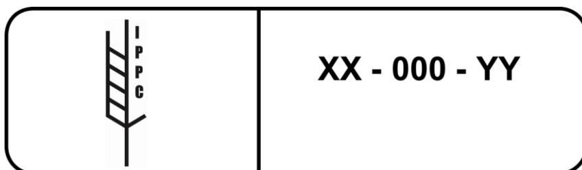
**Пример 4** (Представляет возможный пример маркировки, нанесенной трафаретом; могут быть небольшие промежутки в бордюре и в вертикальной линии, а также в других местах в компонентах маркировки.)
