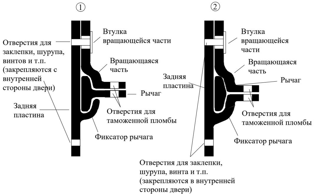
*В частности, опечатывающее устройство № 1 поддается несанкционированному вскрытию в случае невыполнения вышеупомянутых требований. В этой связи предпочтительно использовать устройства, изображенные ниже, поскольку они обеспечивают лучшую защиту от несанкционированного вскрытия до наложения таможенной печати.*
