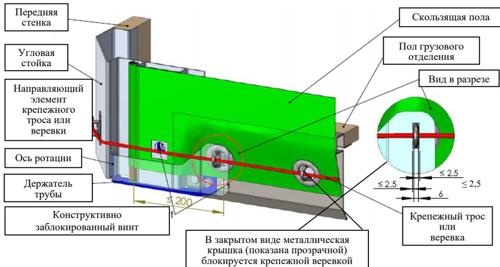
**б) Узкая овальная проушина: система, препятствующая подъему натяжной трубы**
