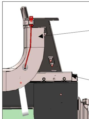
**Устройство натяжения на рычажном механизме. При складывании той части крыши, на которой установлено устройство натяжения, обеспечивается натяжение предварительно напряженного стального троса**
