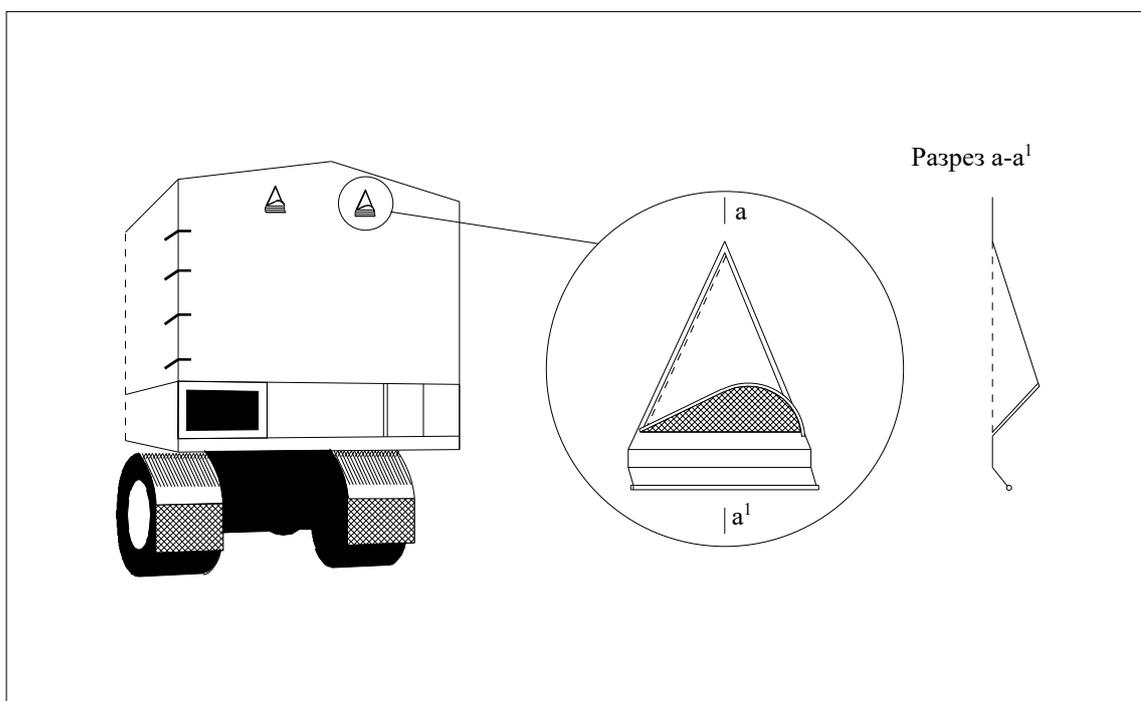
*Вентиляционные отверстия в грузовых отделениях*
