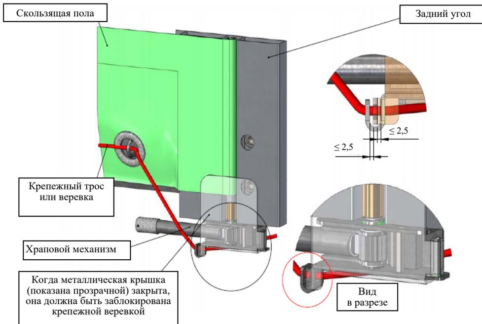
**б) Блокировка храпового механизма**
