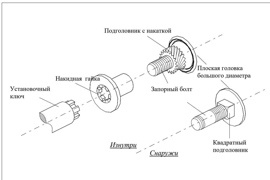
Пневматически устанавливаемые шпильки для крепления полов грузового отделения
