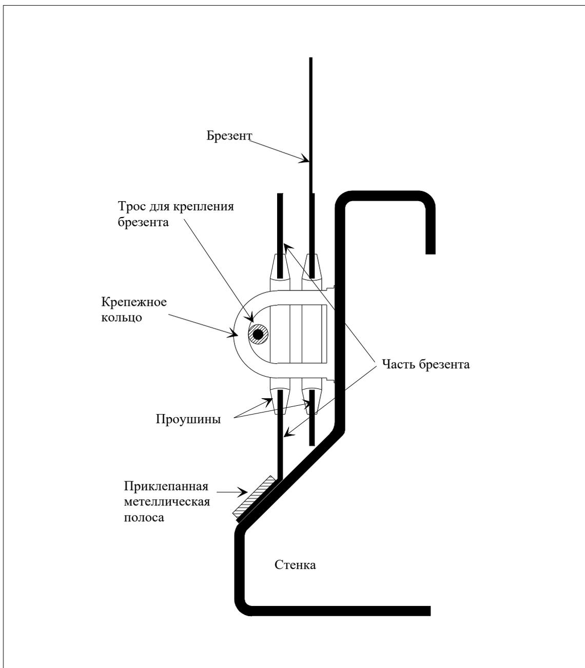
**Рисунок 4****УСТРОЙСТВО ДЛЯ КРЕПЛЕНИЯ ПОКРЫТИЯ**
