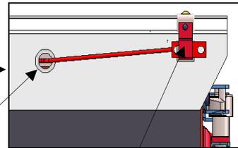
**Предварительно напряженный стальной трос, заделанный в кромке**
