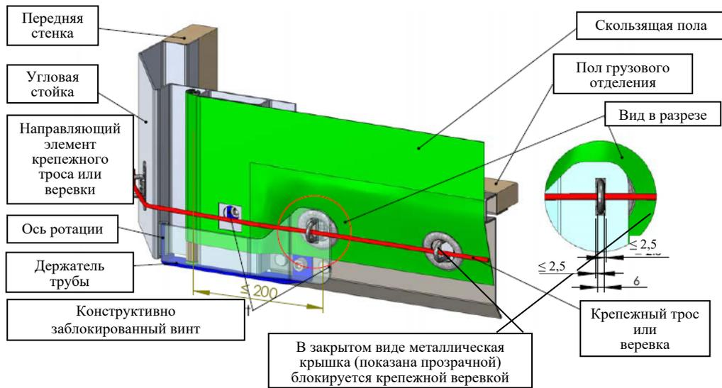
**б) Узкая овальная проушина: система, препятствующая подъему натяжной трубы**
