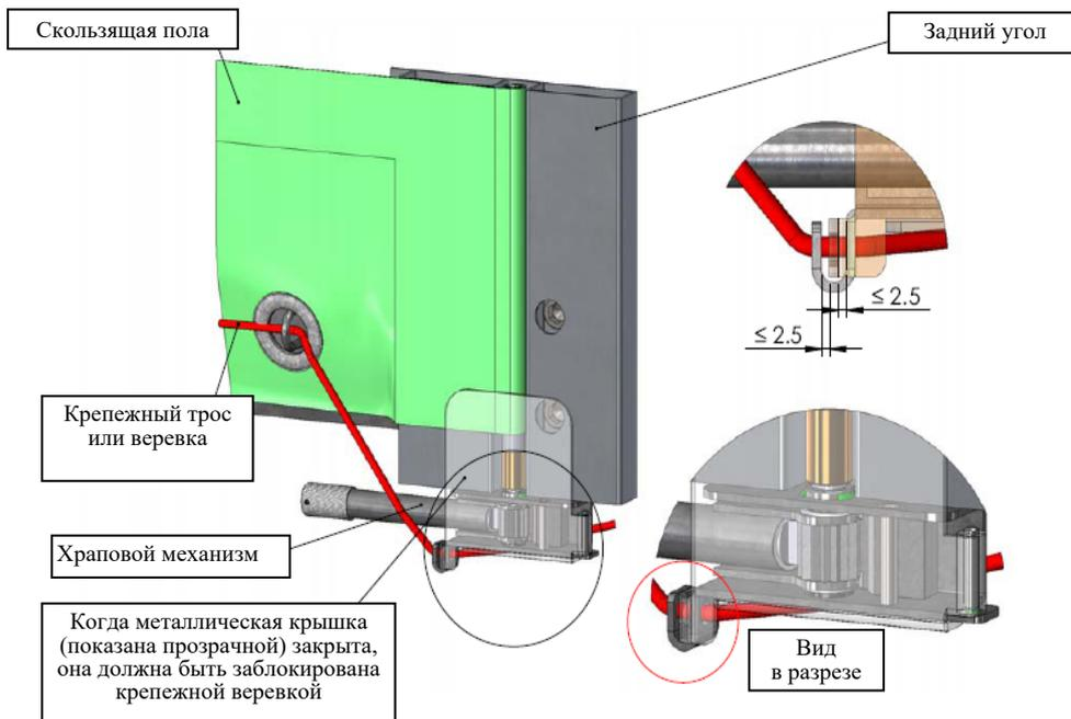
**б) Блокировка храпового механизма**
